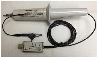
http://i.imgur.com/v2k7hDF.jpg Spannungen bis zu 20 kV<sub>eff</sub> und Impulse bis zu 40 kV (Spitze, 100 ms Dauer) messen. Die Bandbreite von 75 MHz
