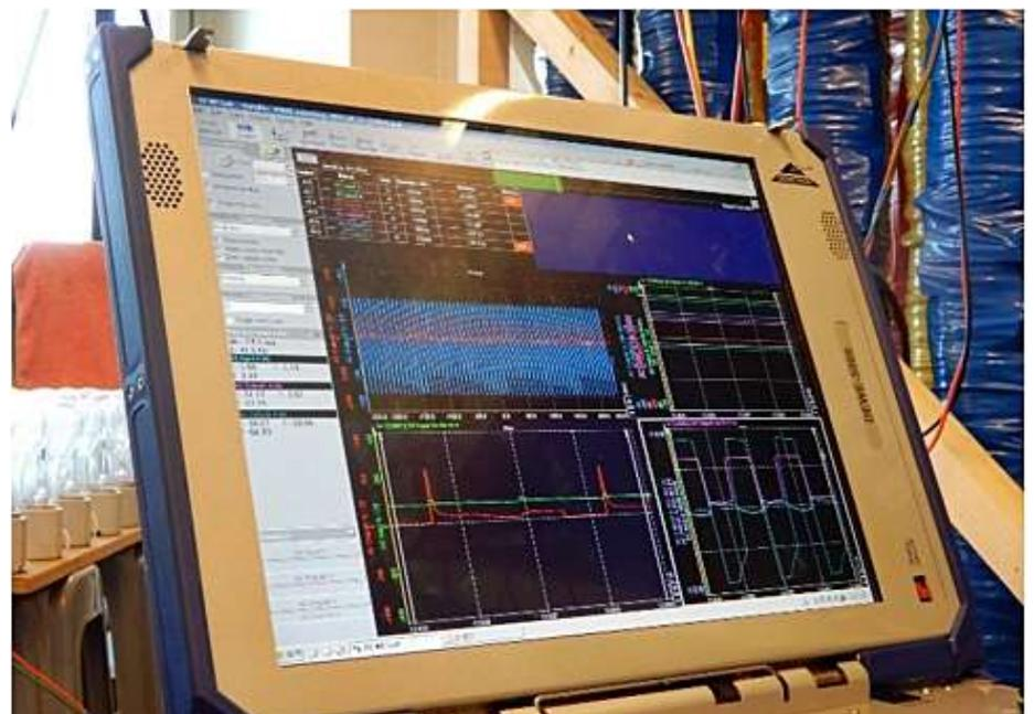
Detaillierte Wiedergabe der Schaltsignale der IGBT-Schalttransistoren.
